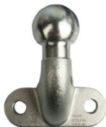
Koule přírubová 2 x M16 mm, rozteč 90 mm
